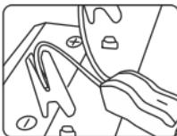
Отключите зажимы в течение 30 сек. после успешного запуска двигателя
