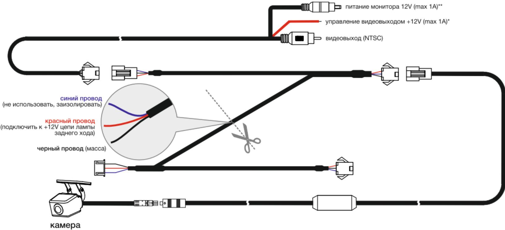
\* подключить к проводу головного устройства, отвечающего за принудительное переключение на видеовыход камеры заднего вида.
