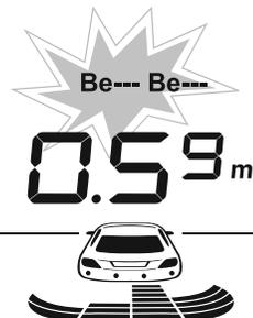
Система активируется при включённом зажигании (АСС) и задней передаче. После этого система выполняет самодиагностику (см. стр. 8) и переходит в рабочий режим. Система активна все время, пока включена задняя передача.
