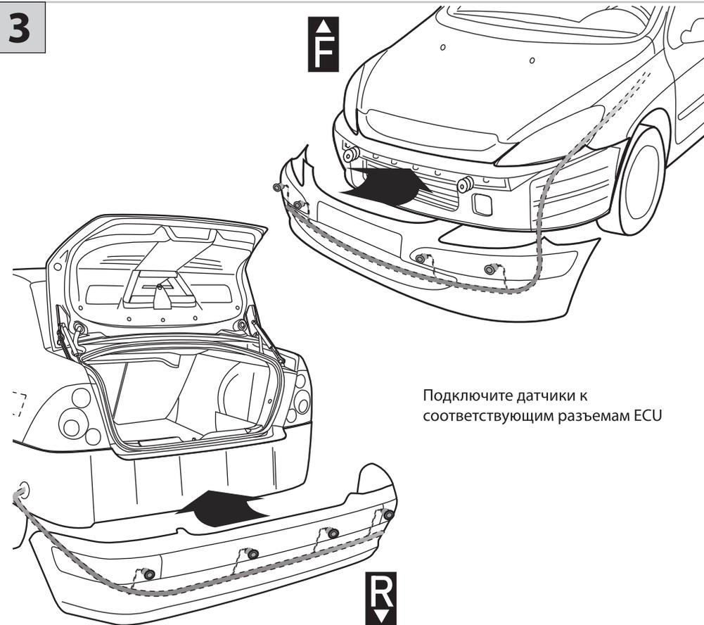
Подключите датчики к соответствующим разъемам ECU
