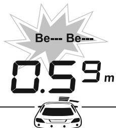
После включения заднего хода система активируется, повторно проводит самодиагностику (см. стр. 8) и работает все время, пока включен задний ход.
