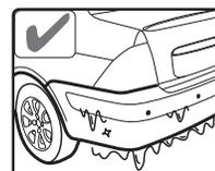
Рекомендуется очищать датчики от снега и наледи с помощью теплой воды.
