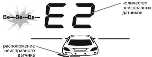
Пример: неисправно два датчика А и В
