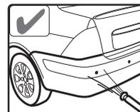
После мойки и/или очистки датчиков, просушите их с помощью сжатого воздуха.
