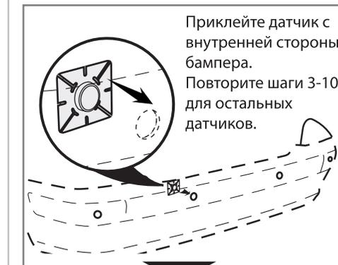
Приклейте датчик с внутренней стороны бампера. Повторите шаги 3-10 для остальных датчиков.
