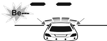
Кратковременно включатся сектора шкалы приближения всех датчиков, прозвучит один звуковой сигнал. Далее система перейдет в рабочий режим.
