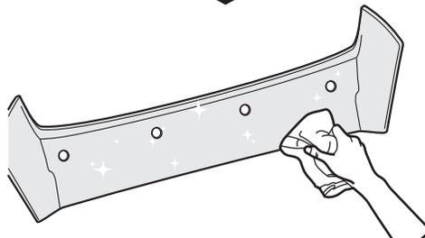
Тщательно очистите и обезжирьте внутреннюю поверхность бампера в местах установки датчиков.
