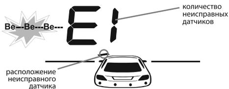
Пример: неисправен один датчик А
