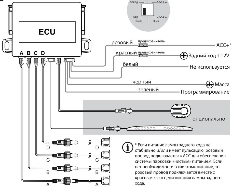
**i** \* Если питание лампы заднего хода не стабильно и/или имеет пульсацию, розовый провод подключается к АСС для обеспечения системы парковки «чистым» питанием. Если нет необходимости в «чистом» питании, то розовый провод подключается вместе с красным к «+» цепи питания лампы заднего хода.
