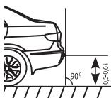
Для установки накладного датчика нагрейте липкую ленту с обратной стороны датчика с помощью фена, удалите защитную пленку и плотно прижмите датчик к чистой поверхности бампера. Уже через 48 часов с момента установки липкая лента даст максимальный эффект.
