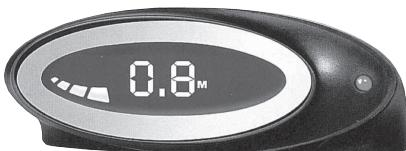
Индикатор "77" представляет собой блок с двумя световыми шкалами, цифровым дисплеем и бипером, подающими водителю световой и звуковой сигналы о наличии препятствия.
